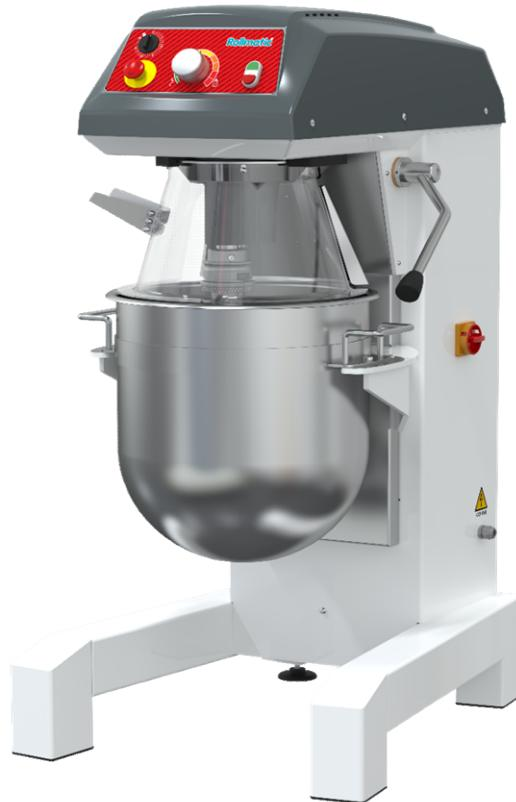
Miscelatore planetario da 80lt indicato per impasti leggeri e per il montaggio di albumi, panna, pan di spagna, etc. Regolazione della velocità con inverter. Monitoraggio di sicurezza della presenza vasca e del riparo vasca. Trasmissione con scatola ad ingranaggi in bagno d'olio. Corona e pignone in acciaio in bagno d'olio, campana ingranaggi in ghisa. Versione inox su richiesta
